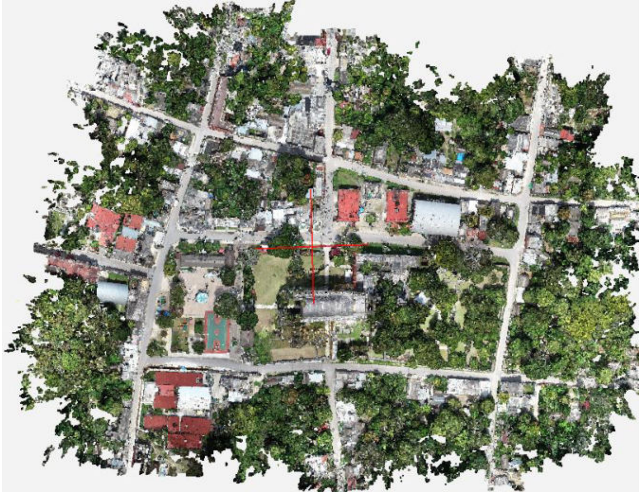
Figura 8. Nube de puntos densa sobre la zona de interés. Obsérvese el grado de densidad y cubrimiento con respecto a la zona circundante a la Iglesia de Tihosuco.
