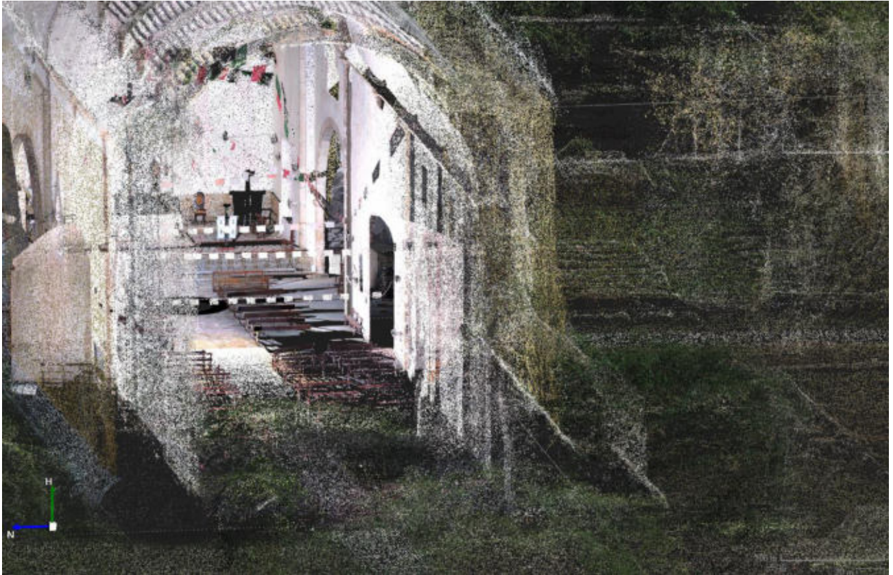
Figura 20. imagen que muestra parte del proceso seguido. Observe como las dos nubes de puntos deben de ser correlacionadas espacialmente. La nube de puntos a la derecha corresponde al interior de la Iglesia de Tihosuco y a la izquierda la Iglesia georreferenciada con control terrestre GNSS.
