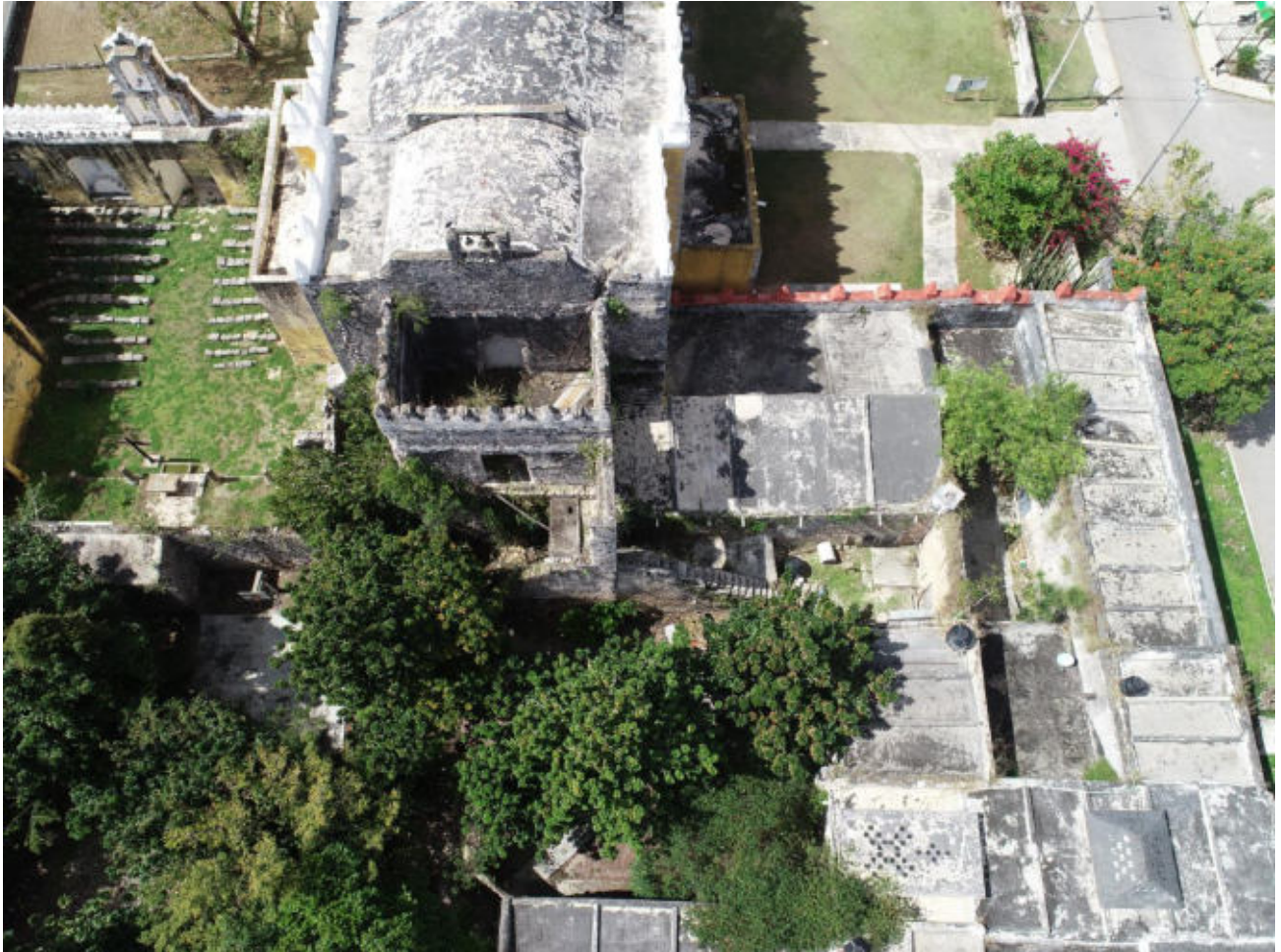
Figura 4. Ejemplo de una de las fotografías aéreas adquiridas para la zona de interés de la Iglesia de Tihosuco. Obsérvese el grado de inclinación empleado que permite retratar parte de los elementos laterales de las construcciones.
