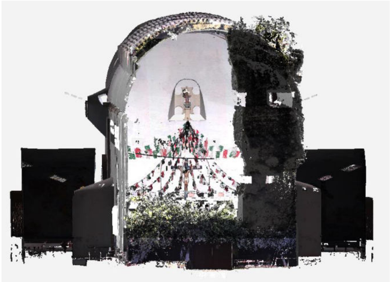
Figura 16. Vista del levantamiento LIDAR en la parte de la sección ubicada al este, lugar que es característico de este monumento por el derrumbe de la pared.
