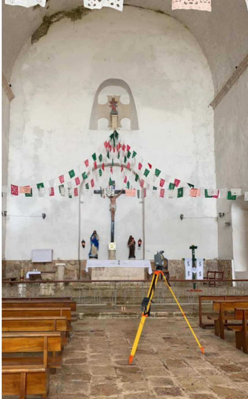
Figura 15. Vista de la ubicación de la estación terrestre LIDAR al interior de la Iglesia de Tihosuco.
