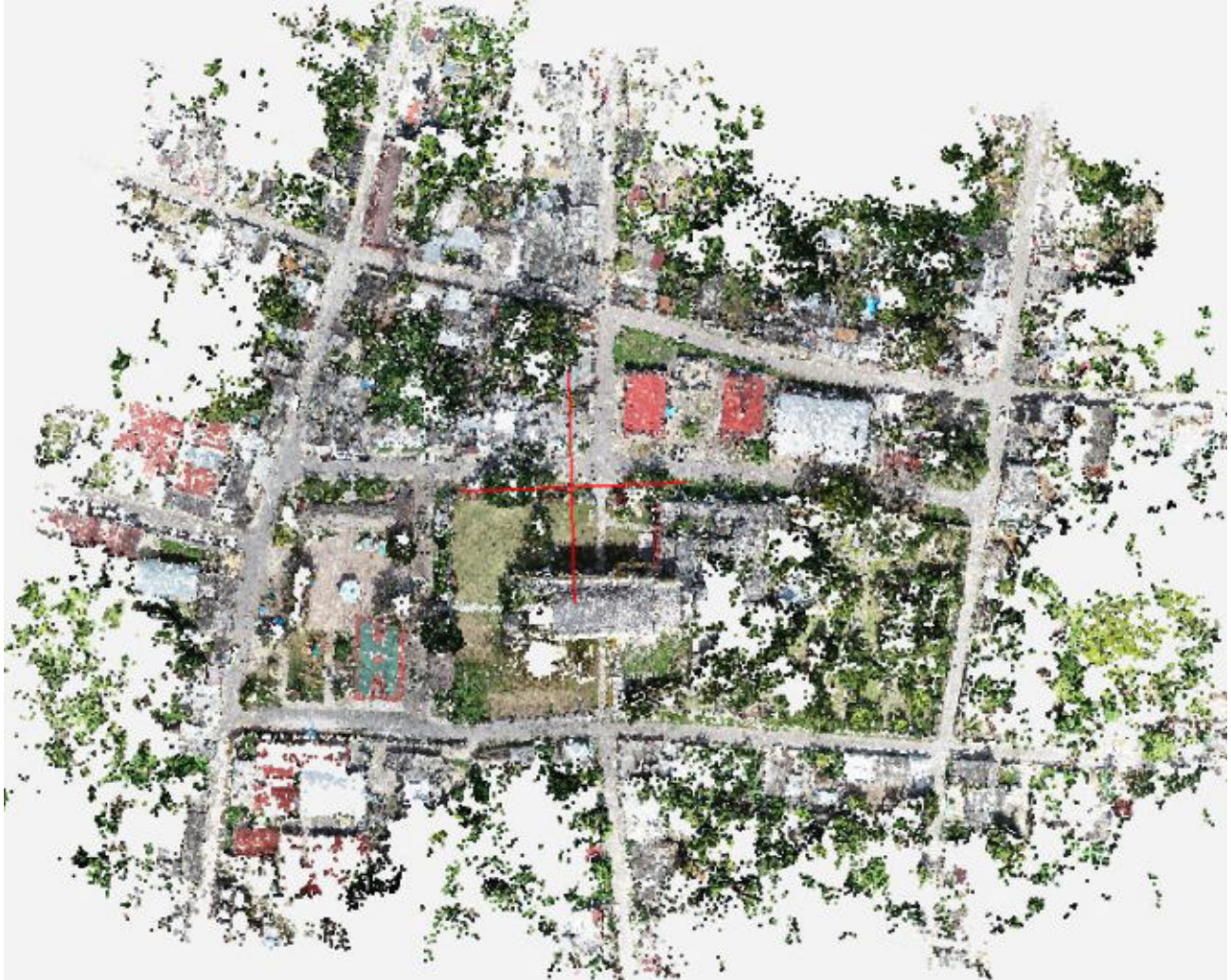
Figura 5. Más de medio millón de puntos conforman la nube de puntos inicial para la zona de mapeo. En la parte central se observa el casco de la Iglesia de Tihosuco.
