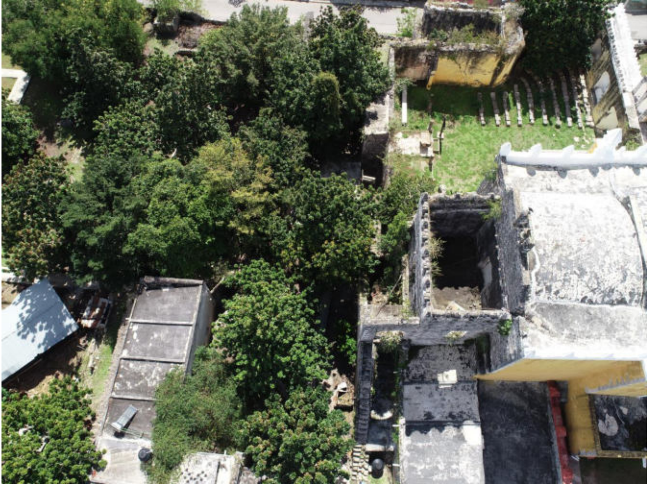
Figura 3. Ejemplo de una de las fotografías aéreas obtenidas con cobertura a la Iglesia de Tihosuco. Obsérvese el alto nivel de detalle; el tamaño del píxel en forma preliminar es de +/- 1.5 cm.
