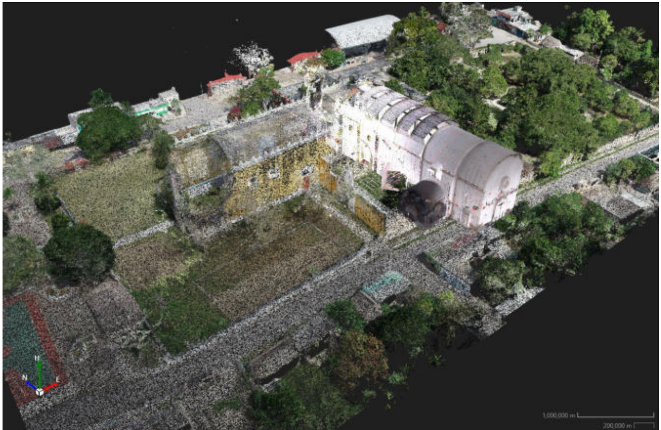
Figura 18. imagen que muestra parte del proceso seguido. Observe como las dos nubes de puntos deben de ser correlacionadas espacialmente. La nube de puntos a la derecha corresponde al interior de la Iglesia de Tihosuco y a la izquierda la Iglesia georreferenciada con control terrestre GNSS.
